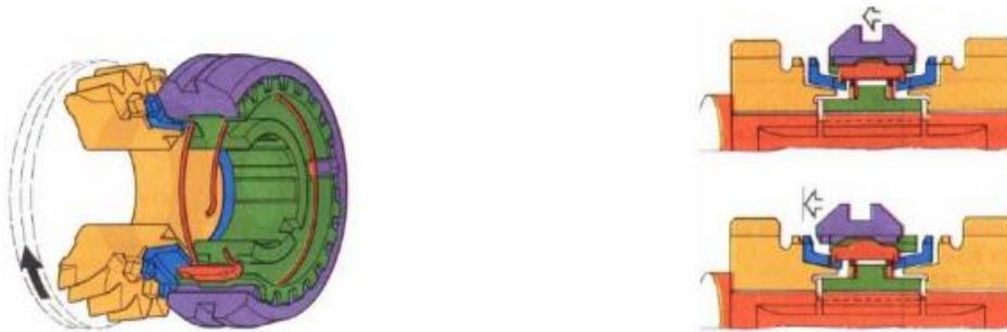
Fig.12 : 1<sup>ère</sup> phase du synchroniseur
