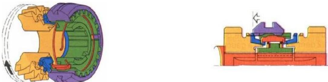
Fig. 13 : 2<sup>ème</sup> phase du synchroniseur
