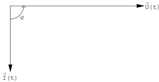
Rappelons que le déphasage  $\varphi$  représente *le retard de phase du courant sur la tension* ou, en d'autres termes, *l'avance de phase de la tension sur le courant*.
