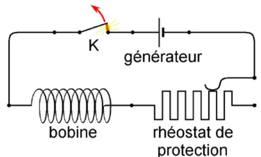
La présence d'une bobine à tendance à retarder la coupure du courant dans la branche où elle est montée, il apparaît une surtension aux bornes de la bobine ce qui se traduit par la formation d'une étincelle de rupture au niveau des contacts de l'interrupteur.
