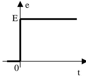
Soit le dipôle R.L série ci-contre alimenté par une source de tension  $e(t)$  produisant un échelon de tension  $E$  à partir de  $t = 0$ .
