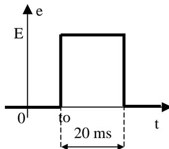
Soit le dipôle R.L série ci-contre alimenté par une source de tension  $e(t)$  produisant une impulsion de tension de largeur 20 ms et d'amplitude  $E$ , à partir de l'instant  $t_o$ .
