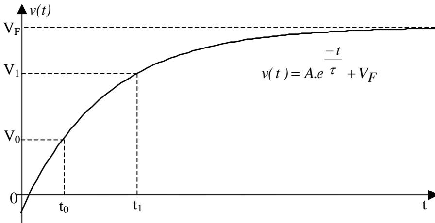
Calculer la valeur de l'intervalle  $\Delta t = [t_0, t_1]$  en fonction de  $V_0, V_1, V_F$  et  $\tau$ .
