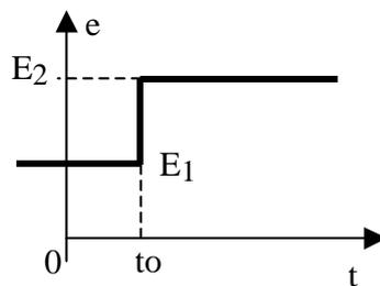
Soit le dipôle R.C série ci-contre alimenté par une source de tension  $e(t)$  produisant une brusque variation à l'instant  $t_0$ .
