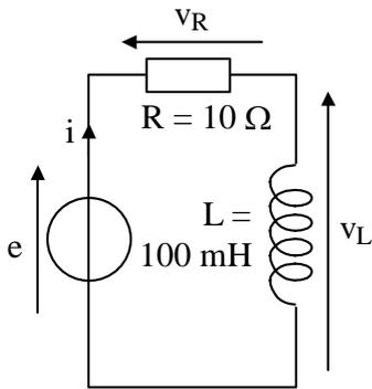
Soit le dipôle R.L série ci-contre alimenté par une source de tension  $e(t)$  produisant un train d'impulsions de tension de largeur 10 ms, de période 20 ms et d'amplitude E. à partir de l'instant  $t_0$ .
