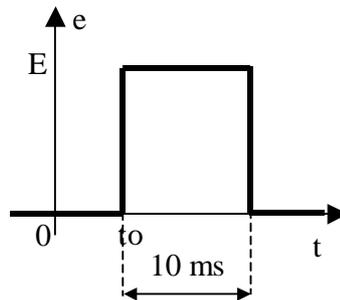
Soit le dipôle R.C série ci-contre alimenté par une source de tension  $e(t)$  produisant une impulsion de tension de largeur 10 ms et d'amplitude E. à partir de l'instant  $t_0$ .
