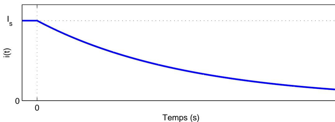
FIGURE 5.6 – Réponse naturelle d'un circuit RL (courant)
