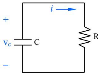
FIGURE 5.8 – Circuit RC, après le changement de l'interrupteur
