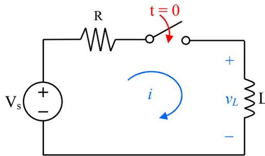
FIGURE 5.9 – Circuit RL, où on applique soudainement une source
