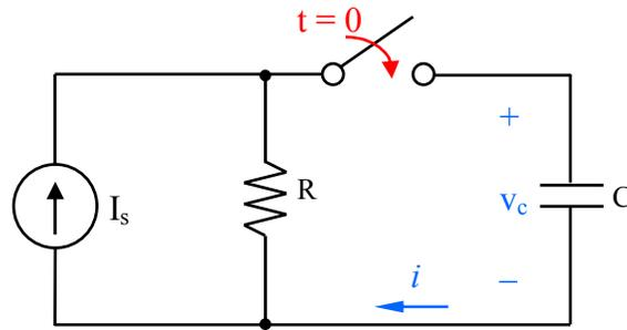
FIGURE 5.10 – Circuit RC, où on applique soudainement une source
