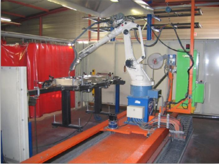
Figure 4 : Robot de soudure
