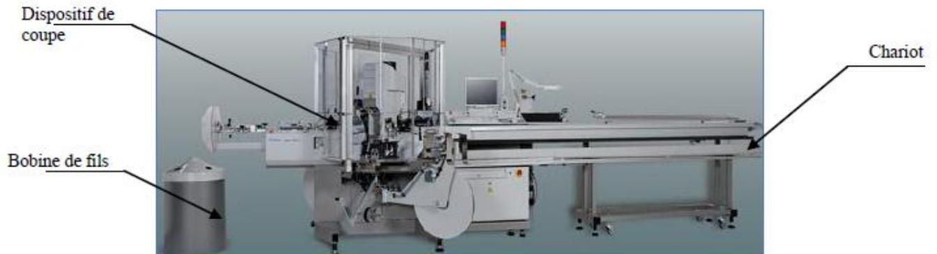
Figure 1.14: Machine de coupe
