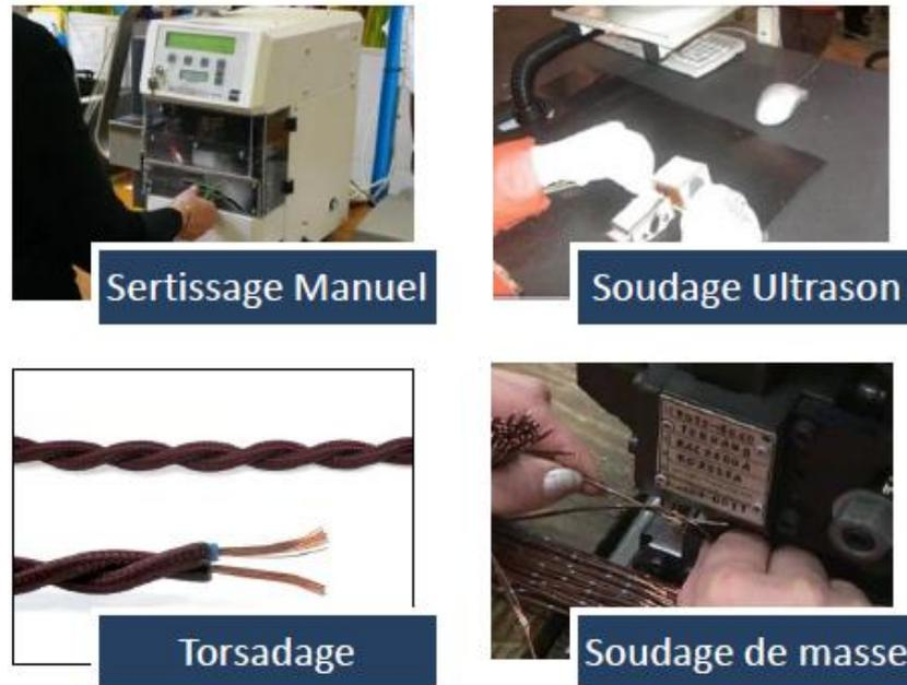
Figure 1.15: Opération de pré-assemblage
