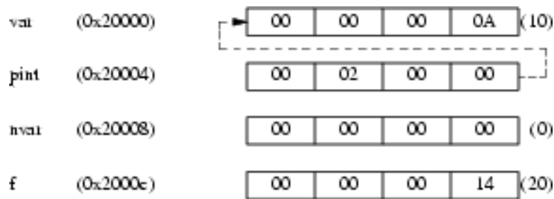
FIG. 5.1 – Exemple de relation entre pointeur et variable
