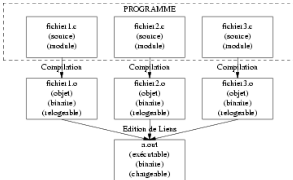
FIG. 9.1 – Du source à l'exécutable
