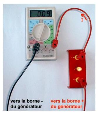
Remarque : L'ampèremètre se comporte comme un excellent conducteur. Mal branché, il peut donc provoquer un court-circuit. Il faudra toujours s'assurer qu'un autre dipôle, capable de limiter l'intensité, est branché en série avec l'ampèremètre.
