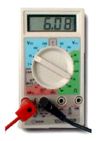
Remarque : Le résultat de la mesure est positif si le très faible courant qui passe dans le voltmètre sort de celui-ci par la borne COM.
