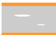
Cavité laminaire dans du mica
