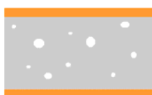
Cavités dans la résine époxy par exemple
