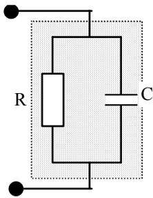
L'entrée de mesure d'un oscilloscope est généralement modélisée par un dipôle constitué d'une résistance  $R$  de  $1\text{ M}\Omega$  en parallèle avec un condensateur ayant une capacité  $C$  de quelques dizaines de pF (légèrement variable d'un oscilloscope à un autre).
