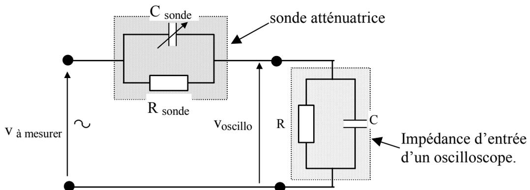
Quelle valeur faut-il donner à  $C_{\text{sonde}}$  pour que la tension  $v_{\text{oscillo}}(t)$  soit égale à  $\frac{v_{\text{à mesurer}}(t)}{10}$  quelle
