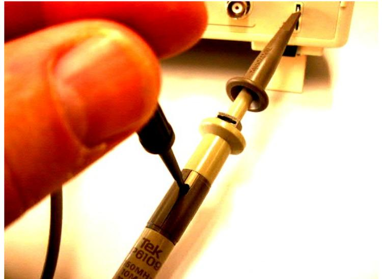
Pour diminuer une tension alternative sinusoïdale à mesurer ou augmenter l'impédance du dipôle de mesure, on ajoute parfois en série avec l'entrée de mesure une « sonde atténuatrice » constituée d'une résistance  $R_{\text{sonde}}$  de  $9\text{ M}\Omega$  en parallèle avec un condensateur  $C_{\text{sonde}}$ . (Ce condensateur est réglable au moyen d'une petite visse)
