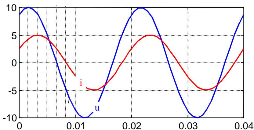
Soit une impédance  $\underline{Z}$ . Le courant dans  $\underline{Z}$  est  $i(t)$ , et la tension à ses bornes est  $u(t)$  (en convention « récepteur »).
