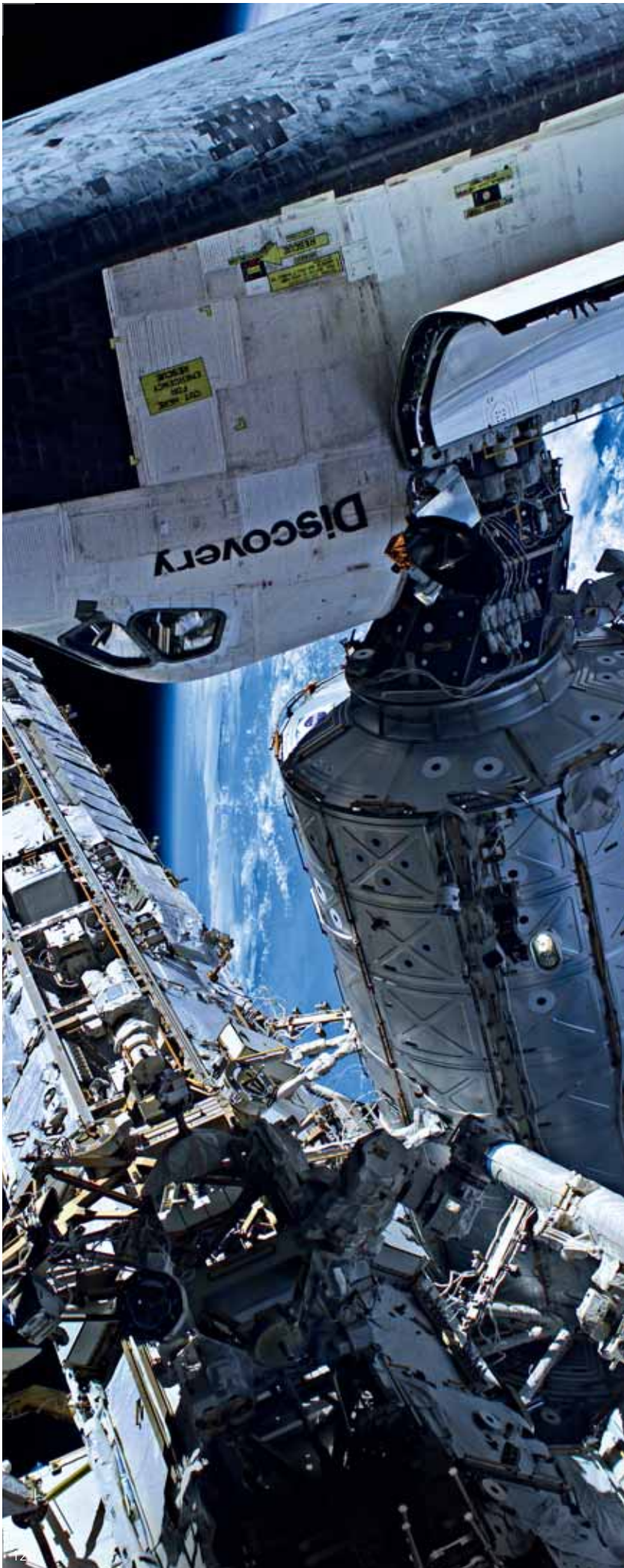
La station spatiale internationale est le plus grand objet artificiel placé en orbite terrestre. Une fois achevée, elle occupera un volume de 1250 m 3 pour un poids d'environ 420 tonnes. Plusieurs vaisseaux se relaient pour amener les composants, réaliser le ravitaillement et relever l'orbite régulièrement dégradée par la traînée atmosphérique.
