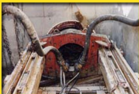
Microtunnelier avec son noyau de marinage
