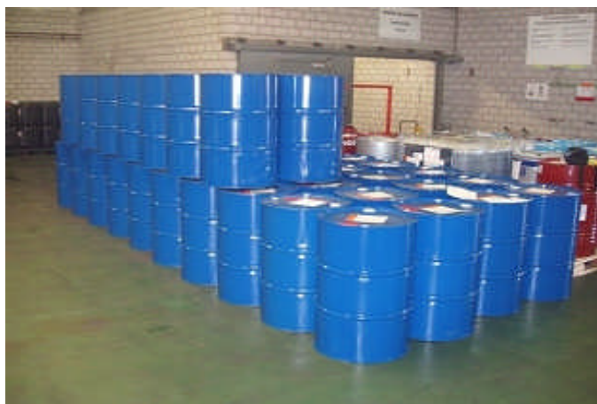
Entrepôt de stockage par empilement (Photo: Office de la protection des eaux et de la gestion des déchets, canton de BE)
