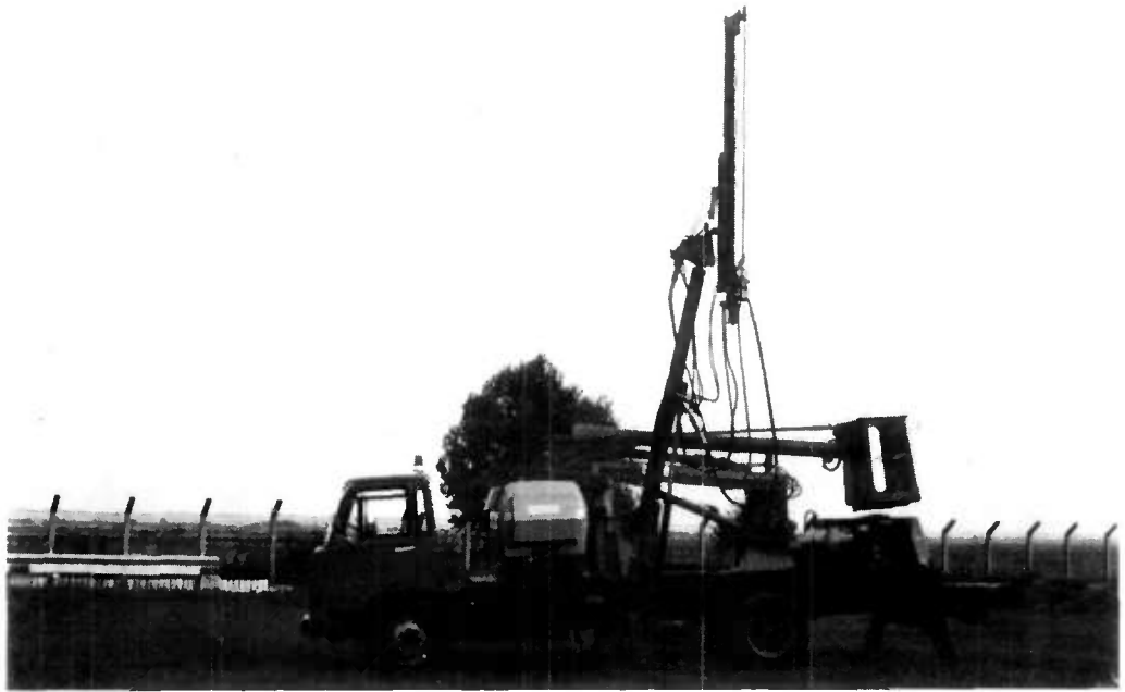
Figure n° 8. Centrale d'inspection des tunnels routiers. La plate-forme du camion est équipée d'une nacelle élévatrice hydraulique et d'un bras de foration orientable dans toutes les directions alimenté par un groupe compresseur muni d'un épurateur. L'éclairage est assuré par une rampe de quatre projecteurs de 70 W chacun.
