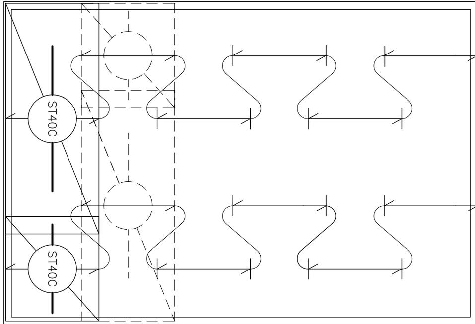
**Fig. 46:** Exemple de calepinage des TS de la nappe inférieure d'une dalle.
