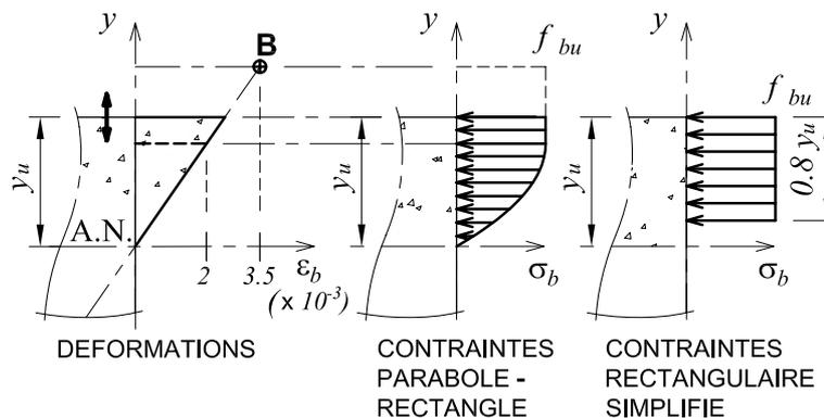
**Fig. 25 :** Définition des diagrammes contrainte-déformation parabole-rectangle Figure (8) et rectangulaire simplifié dans la section de béton comprimé
