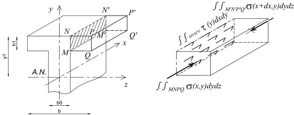
**Fig. 42:** Notations et équilibre d'un demi-hourdis d'une poutre en T.
