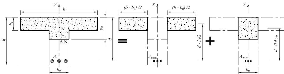
**Fig. 34** : Principe du calcul de la section d'acier pour une poutre en T à l'ELU : le moment ultime est repris d'une part par les débords de la table et d'autre part par la partie de l'âme au dessus de l'axe neutre.
