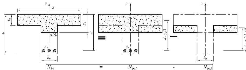
**Fig. 35** : Principe du calcul de la section d'acier pour une poutre en T à l'ELS : la résultante des contraintes de compression est calculée comme la différence des contraintes s'appliquant sur une surface  $b \times y_1$  en  $2y_1/3$  et celles s'appliquant sur une surface  $(b - b_0) \times (y_1 - h_1)$  en  $2(y_1 - h_1)/3$ .
