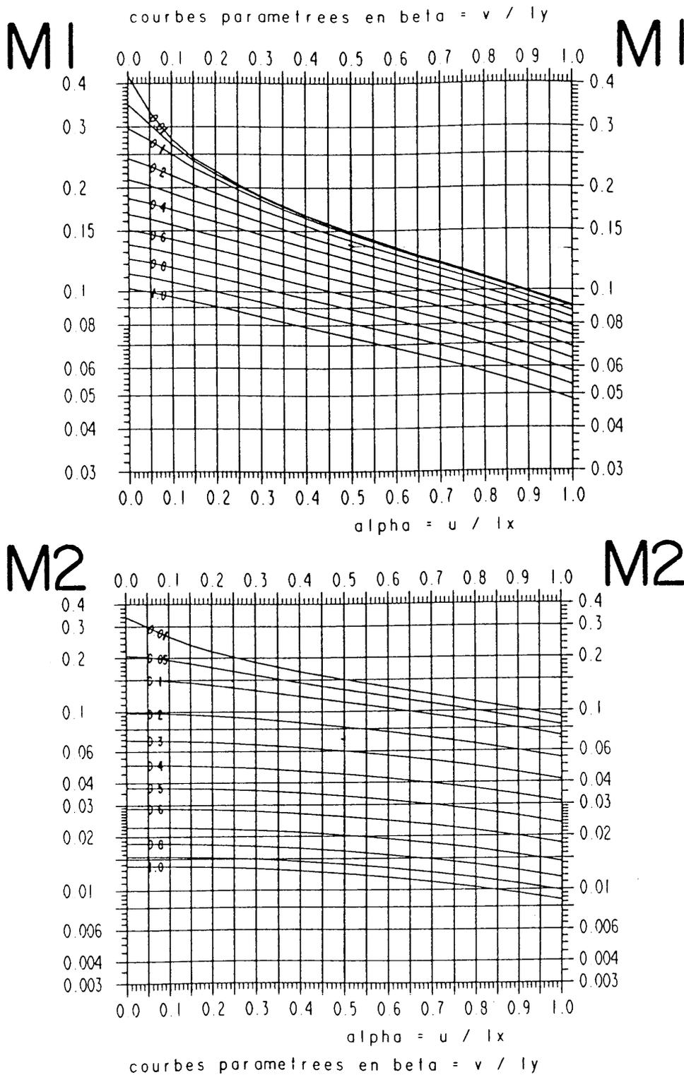
**Fig. 44** : Abaques de Mougins pour le calcul des moments dans une dalle de dimensions  $l_x/l_y = 0.5$  supportant une charge uniforme sur un rectangle de dimensions  $a \times b$ . Voir le texte pour l'utilisation.
