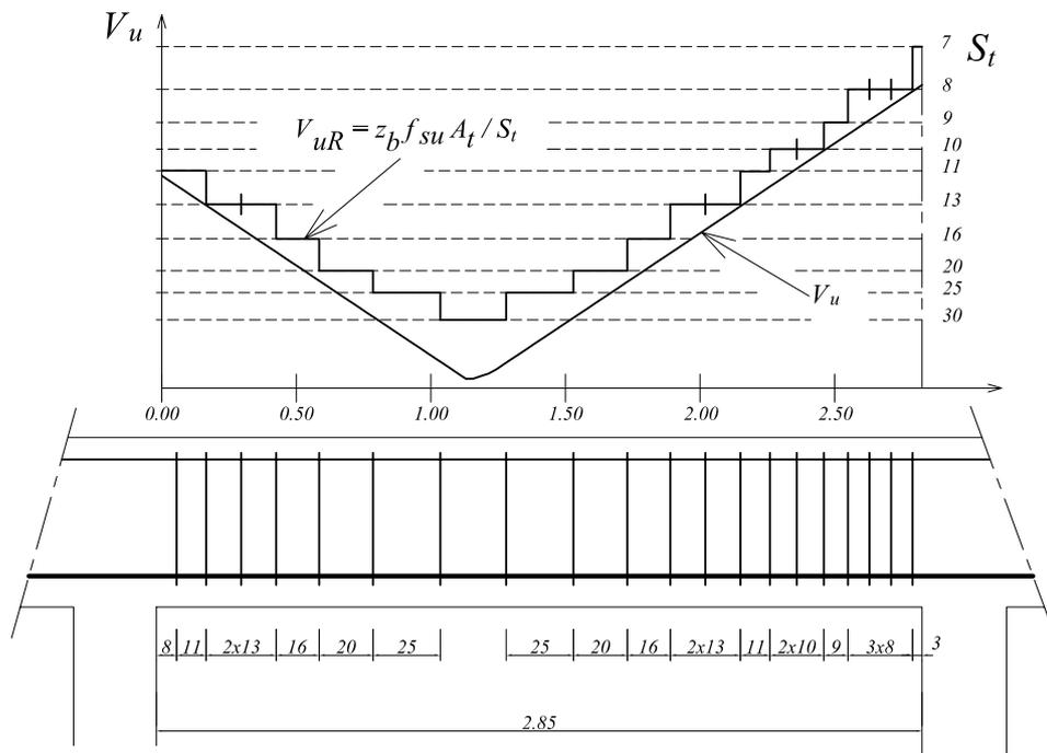
**Fig. 38** : Exemple de tracé de la répartition des cadres dans une poutre en fonction de la courbe enveloppe de l'effort tranchant.
