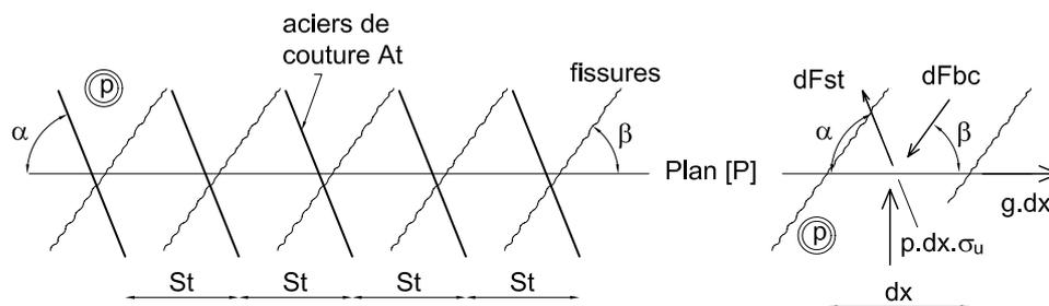
**Fig. 41:** Equilibre d'une surface élémentaire du plan  $[P]$ .
