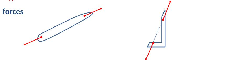
• Il s'agit généralement d'une barre droite articulée aux deux points d'application des forces (Nœuds). Ces forces sont nécessairement égales de sens opposées et colinéaire pour assurer l'équilibre. Ces barres peuvent être soit en tension soit en compression
