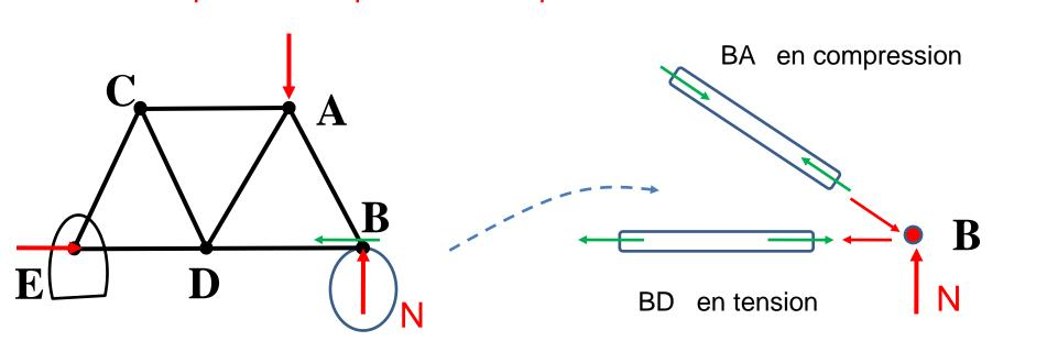
Dans le cas d'un treillis isostatique pour les forces extérieures, il existe une relation précise entre le nombre de ses éléments et le nombre de ses nœuds nécessaire pour réaliser une stabilité intérieure sans redondance. En effet
