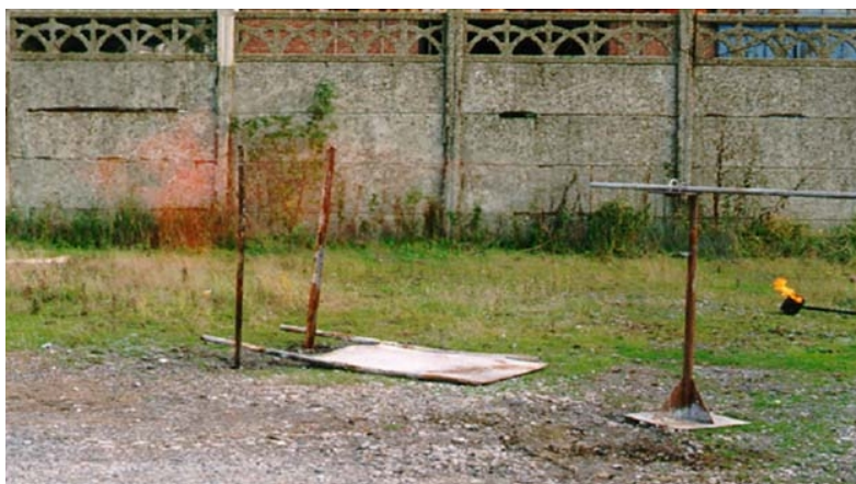
FIGURE 2.2 – Photo d'une flamme d'hydrogène, particulièrement dangereuse pour les équipes d'intervention puisque peu visible à l'œil nu.
