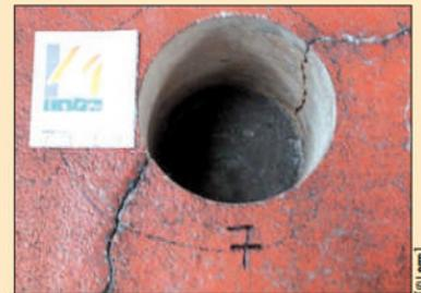
Le retrait correspond à des variations dimensionnelles mettant en jeu des phénomènes physiques avant, pendant ou après la prise des bétons. Sa conséquence visible est l'apparition de fissures.
