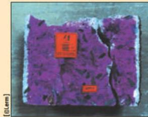
Fig. 4 • Profondeur de carbonatation hors fissure.
