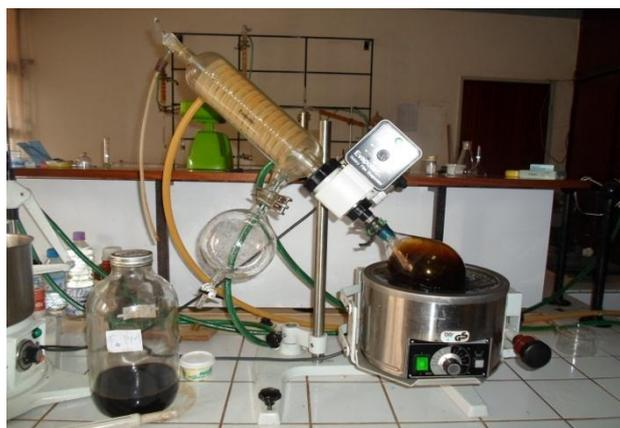
**Figure 1.** Evaporateur rotatif EVAPOTEC® utilisé pour la préparation de l'extrait EHA-CTH
