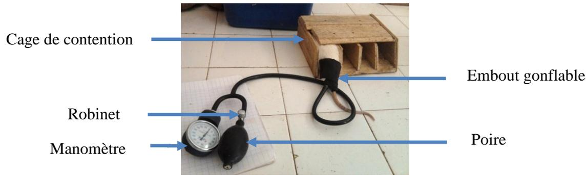
**Figure 2.** Dispositif expérimental de mesure de la pression artérielle caudale chez les rats.
