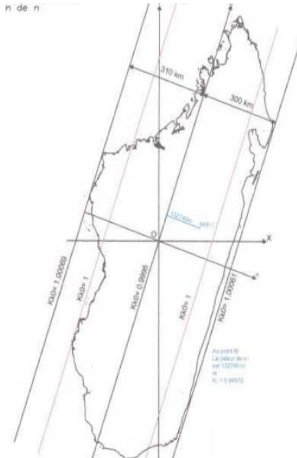
Figure 17: Variation du coefficient KK_0 en fonction de n
