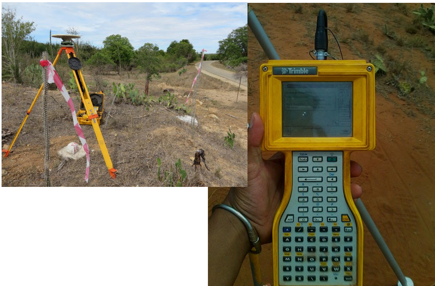
Photo 2: Calibrage de la GPS TRIMBLE 5700
