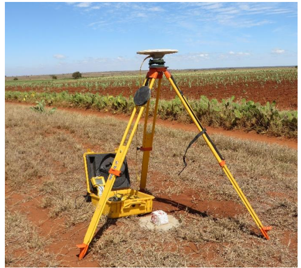
Photo 3: GPS trimble Juno R4 et GPS trimble 5700
