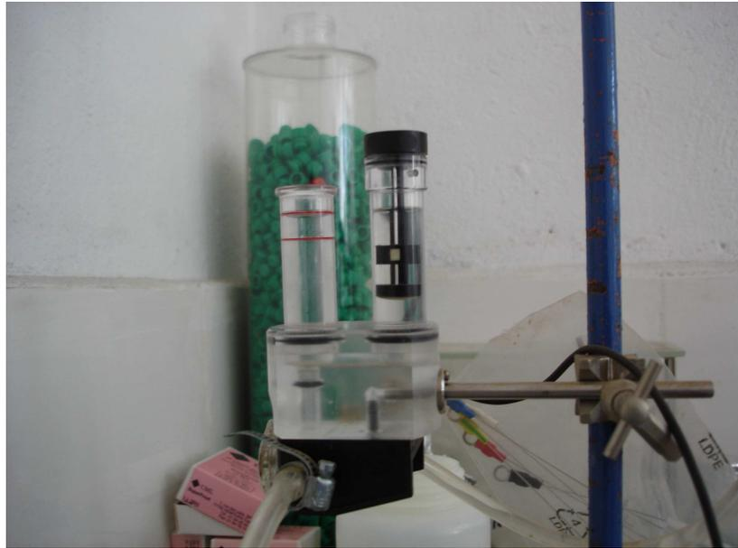
Figure 22 : Cellule de mesure d'une pléthysmomètre [auteur]
