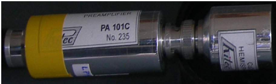
Figure 15: Image du détecteur avec le préamplificateur
