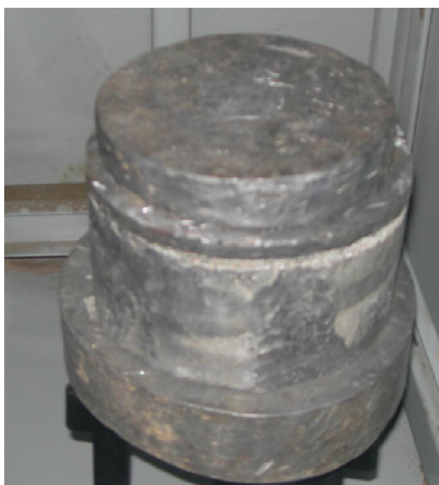
Figure 21 : image du blindage en plomb
