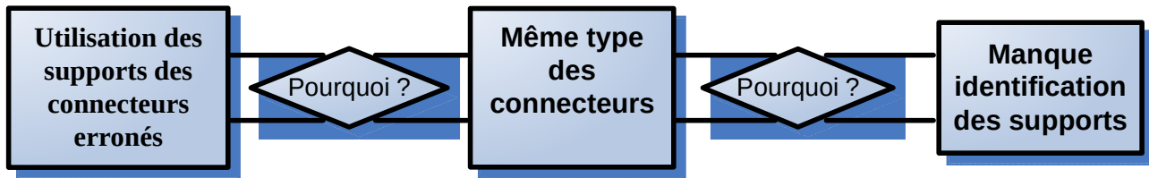
Figure 4.9 : analyse des causes du défaut Branche mesure incorrecte par la démarche 5 Pourquoi
