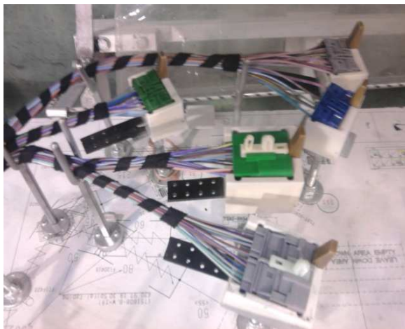
Figure 4.14 : Etat avant et après amélioration de l'utilisation des supports des connecteurs erronés.
