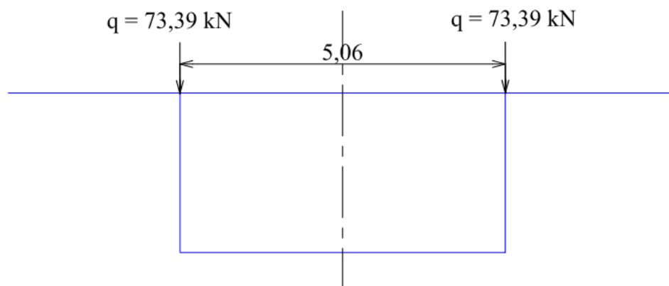
Figure 58 : Effort tranchant pour le cas de charge symétrique
