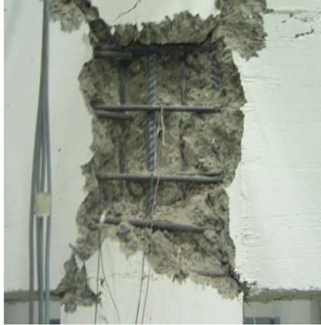
*Figure 10.21. Etat Limite Ultime d'un nœud correctement armé dans une situation « poutre forte-poteau faible ».*
