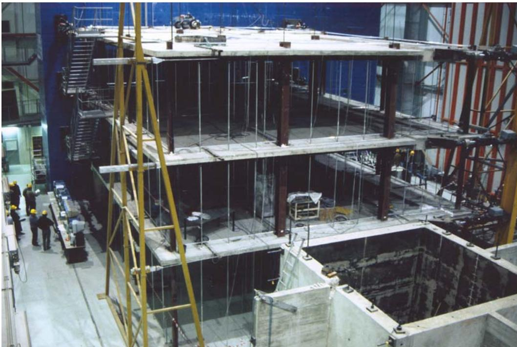
Figure 12.10. Essai en vraie grandeur sur ossature mixte en portique exécuté au CCR Ispra (I). (Plumier&Doneux, 2001).
