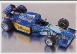
Structure monocoque, éléments de carrosserie en matériaux composites moteur Renault 10 cylindres en V Cylindrée 3500 cm<sup>3</sup>, alésage et course non communiqués alimentation par injection Puissance 740 ch à 14300 tr/mn. Boîte de vitesse semi-automatique à 6 rapports Poids 505 Kg Vitesse maximale 331 km/h
