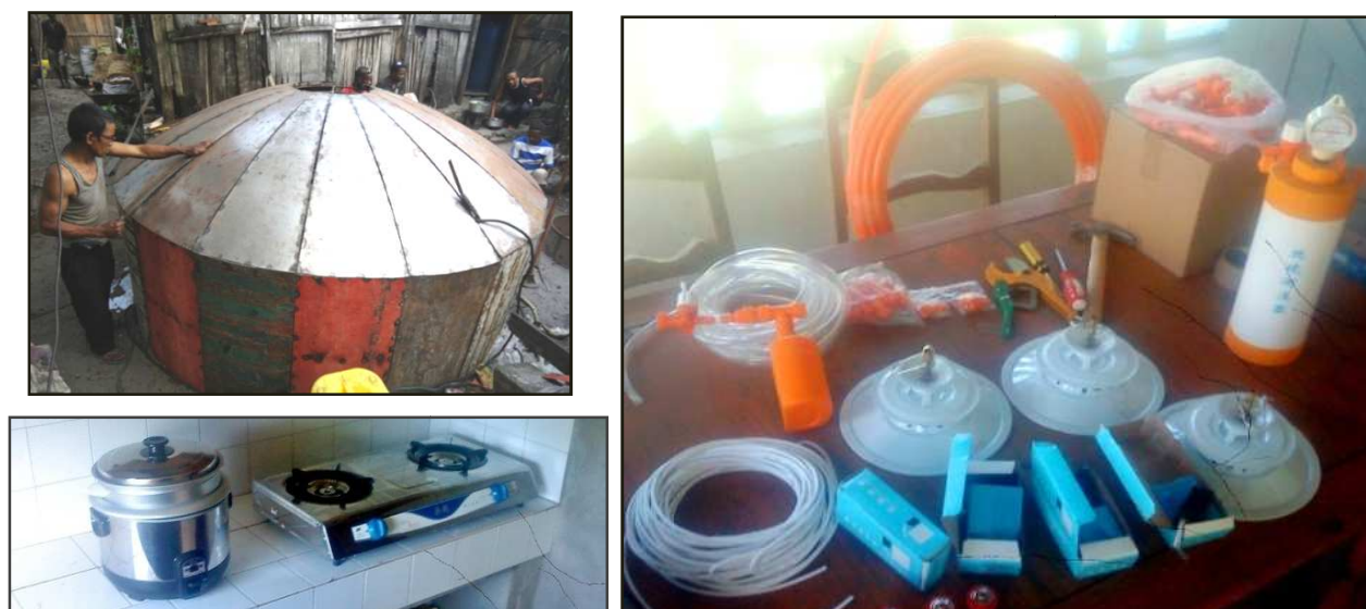
Photo n° 2 : Moules confectionnés et kits biogaz
