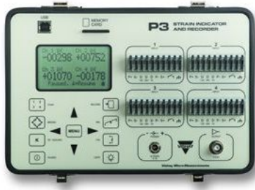
FIGURE 1.6.4 – Conditionneur pont de Wheatstone (doc. VISHAY)
