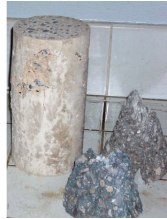
FIGURE 3.2.2 – éprouvettes de béton après essai de compression
