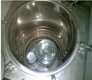
Photo 2: Carbonisation dans l'autoclave
