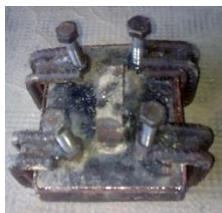
Photo 11: Pressage et activation de la colle dans le four
