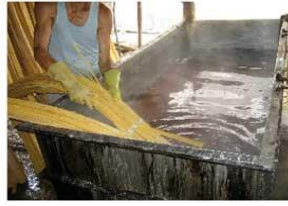
Figure 46: Traitement chimique des lamelles
