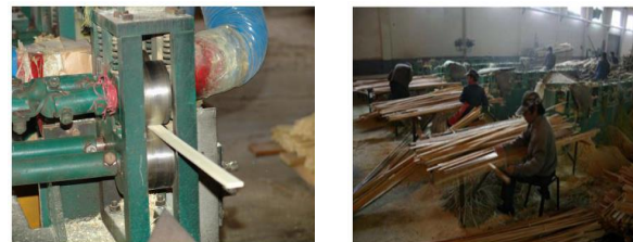
Figure 45: Rectification des lamelles
