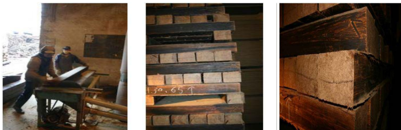
Figure 51: Sciage des poutres
