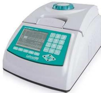
**Figure 11. Thermocycleur MultiGene, Labnet® pour PCR classique**
