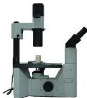
Figure 10. Moyens d'échantillonnage et d'identification du phytoplancton selon la méthode d'Utermöhl (1958)
