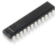
Un circuit MAX7219, multiplexeur spécialisé dans la gestion d'affichage à LED
