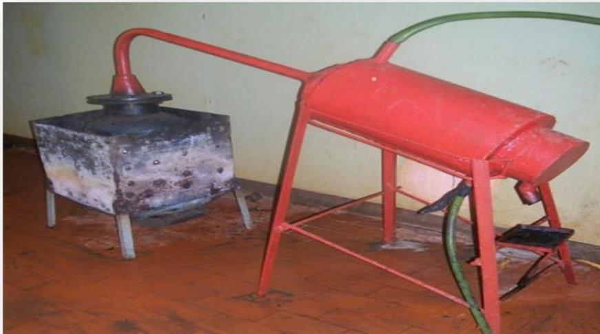
**Photo 10: Unité de pyrolyse de bambou.**
