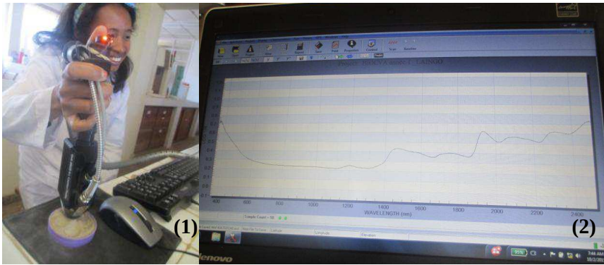
Photo 3 : Lecture d'un échantillon avec la sonde (1) et spectre obtenu (2).
