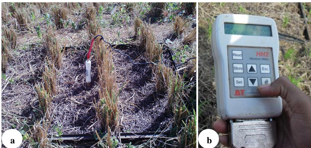
Cliché 5: Mesure de l'humidité du sol : a) capteur enfoncé dans le tube – b) appareil de lecture
