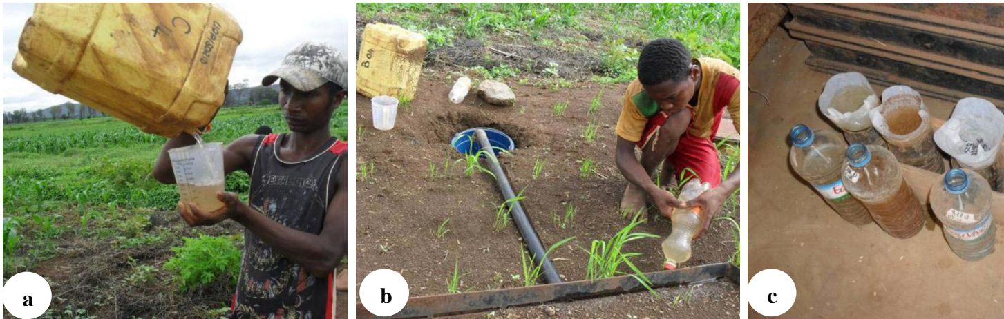
Cliché 4: Opérations des mesures de ruissellement et des sédiments : (a) mesure de ruissellement – (b) rinçage des fentes – (c) filtration des échantillons
