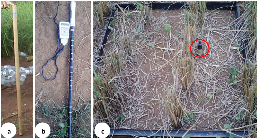
Cliché 1: Humidimètre avec sonde théta : a) tube à enfoncer dans le sol – b) boîtier composant des capteurs d’humidité – c) sonde mise en place
