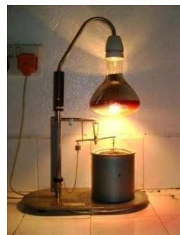
Figure 23: Appareil à tester l'humidité (cliché : auteur, 2009)
