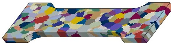
FIGURE 3.10: Microstructure générée par *Germination*. Les couleurs servent uniquement à distinguer les grains les uns des autres.
