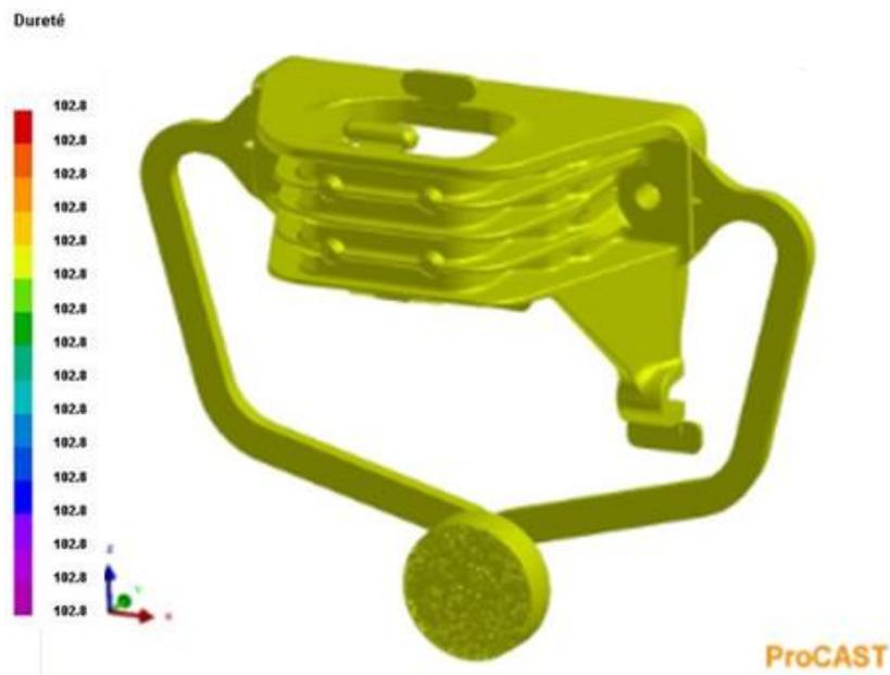
Figure 94: Cartographie de la dureté (HBw) de l'alliage 3
