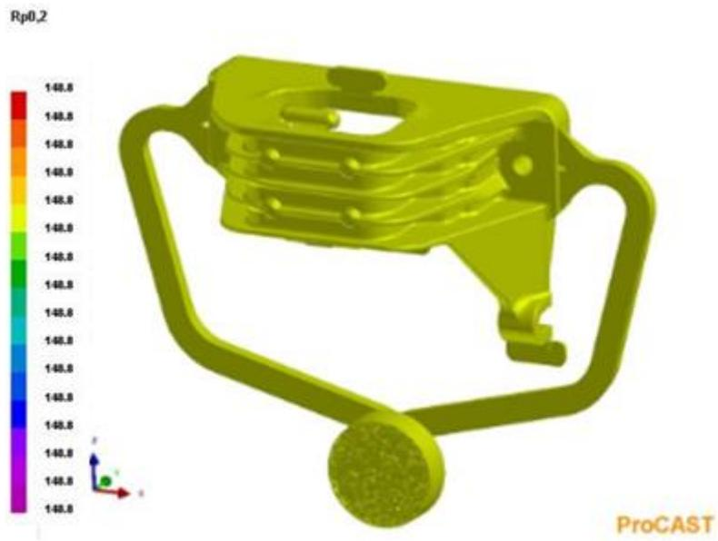
Figure 95: Cartographie de la limite élastique(MPa) de l'alliage 3
