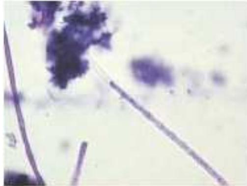
Figure 14 : Mise en évidence de la gaine par coloration au cristal violet (d'après FNDAE N°33)
