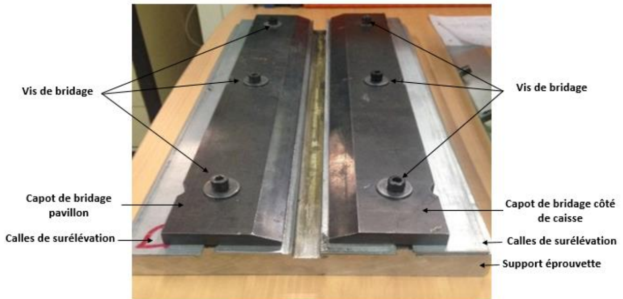
Figure II.8 – Photo du support éprouvette.
