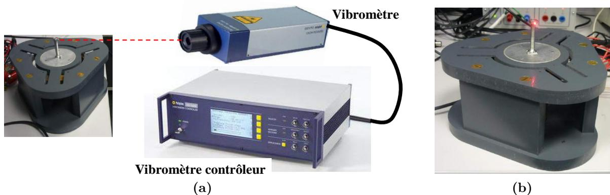
Figure 4.26: Principe de mesure de la vitesse
