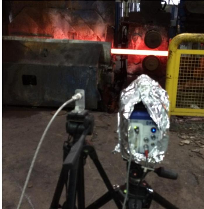
Figure 69 : Relevé de températures avec un pyromètre bi-chromatique et une caméra thermique afin d'évaluer la valeur de l'émissivité
