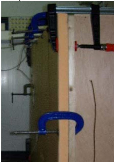
Figure 4.30 - Caractérisation du cadre en polystyrène de 40 mm d'épaisseur
