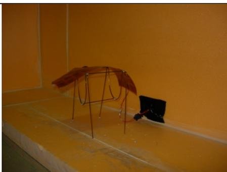
Figure 4.20 Résistance électrique à l'intérieur de la cellule
