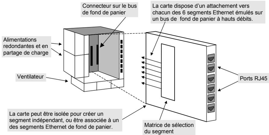
Il est possible d'insérer différents types de cartes dans un châssis : concentrateur Ethernet, commutateur Ethernet, carte Token-Ring, FDDI, ATM, etc. Il est également possible de combiner les débits (10, 100 et 1 000 Mbit/s) sur des segments séparés. Mais, attention, il n'est en aucun cas possible de mélanger des débits sur un même segment Ethernet. De même, les réseaux Token-Ring, FDDI et ATM créés seront indépendants.
