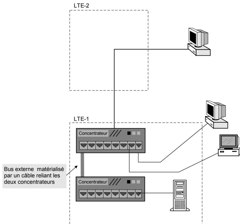
S'il y a davantage de PC, ou, d'une manière générale, s'il n'y a plus de câbles de rcade en nombre suffisant (en général, entre 6 et 12), il suffit de créer un autre réseau sur le même modèle. Le problème est maintenant de connecter les réseaux construits sur les deux étages pour que tout le monde puisse accéder aux mêmes données et aux mêmes applications.
