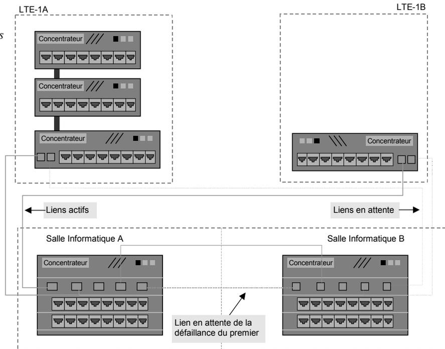
Les liaisons en pointillé sont inactives en fonctionnement normal. En cas de rupture de la liaison principale, le concentrateur d'étage active la seconde liaison en quelques microsecondes.
