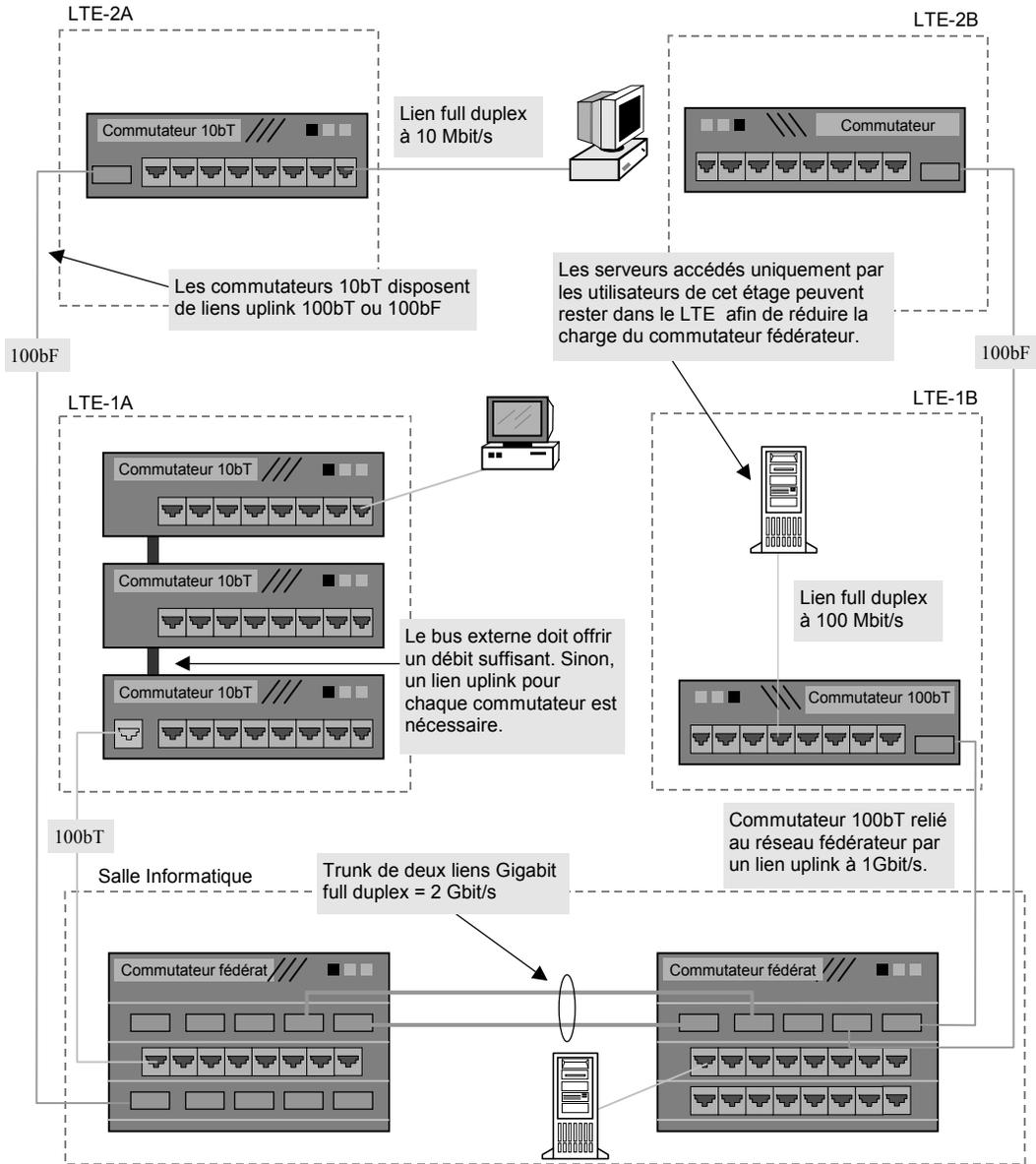
Au niveau du réseau fédérateur, la capacité d'accueil doit être augmentée. La sécurité de fonctionnement doit également être améliorée, car la panne de l'équipement central entraînerait l'arrêt de tout le réseau. Le ou les commutateurs empilables doivent donc faire place à un châssis plus performant (en termes de bande passante de la matrice de commutation) et qui offre des alimentations redondantes.
