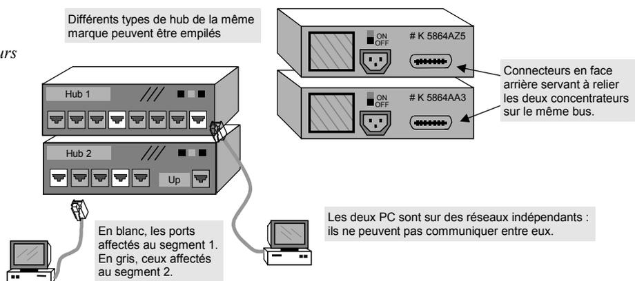
Une autre solution consiste à installer des châssis, certes plus chers, mais qui offrent de plus grandes capacités d'accueil. Ces équipements permettent de créer plusieurs segments indépendants à des débits différents.
