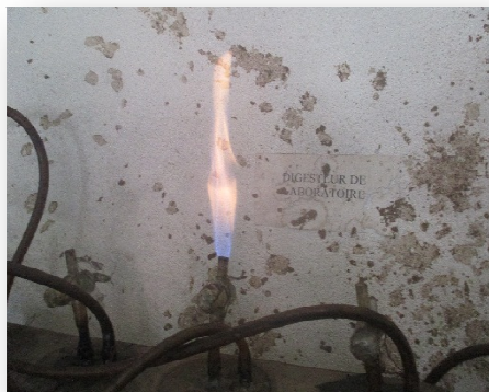
Figure 21 : Flamme du biogaz en dessus du gazomètre
