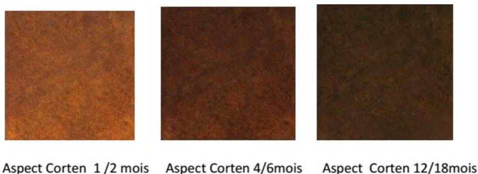
**Figure 115: Phase de vieillissement de l'acier Corten**
