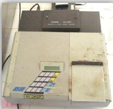
Photo 7: spectromètre
